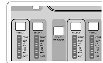
“Sends on Faders”(推子发送)功能对发送至 16 个混音母线的任一通道电平设置有辅助作用。
