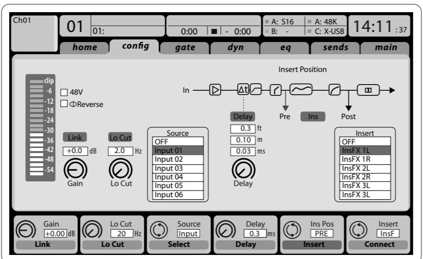
可对输入通道 1-32 预置以连接前 32 个输入信号, 但也可将它们补入以连接调音台 DSP 补丁上的任何其他可用信号。在 Preamp Config 页面可改变通道音源。
