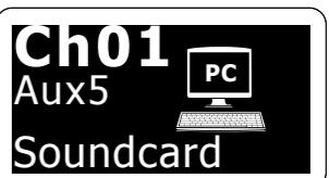
例如, 通道 01 为 Soundcard(声卡)通道, 通过 Aux 5 进行输入连接。
