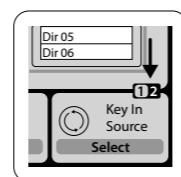
主显示屏上的一些独立页面包含的可调节参数比位于显示屏下面的 6 个旋转编码器控制的还要多。此种情况下, 会出现一个小的页面号显示, 如“1/2”; 按下 Layer Up/Down 可在各层之间进行切换。
